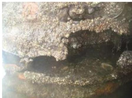
**Figuras 7 e 8 – Corrosão severa em elementos de aço de estacas. (acervo MRS Logística)**
