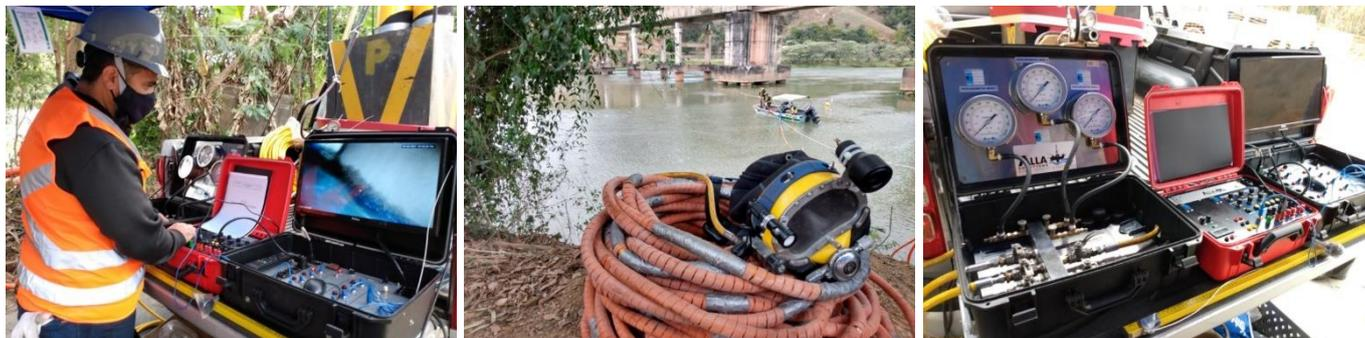
**Figuras 1 a 3 – Inspeção de ponte utilizando mergulhadores profissionais (acervo do autor)**
