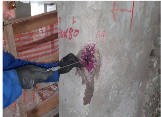
Figura 3. Aspecto do concreto após aplicação da fenolftaleína.
