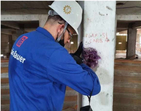
Figura 2. Exemplo de ensaio de profundidade de carbonatação em um dos pilares do Bloco 2.
