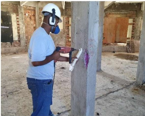
Figura 4. Coleta de material do Bloco 1 para o ensaio de cloretos.
