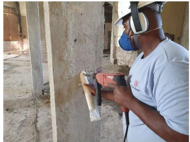
Figura 5. Coleta de material do Bloco 2 para o ensaio de cloretos.
