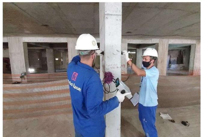
Figura 7. Ensaio de ultrassonografia dinâmica realizado pelo método direto.
